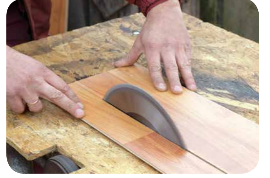
استخدام الآلة قطع الخشب من دون تركيب/استخدام واقي للحماية
