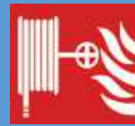
معدات الحريق بكرة خرطوم الحريق
