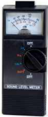
جهاز بسيط لقياس مستوى الصوت
