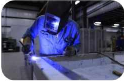
تغطي ملابس العمل وأجهزة الحماية الشخصية جميع أنواع البشرة المكشوفة، مع واقى مظلم لحماية الوجه والعيّن من الأشعة فوق
