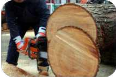
عامل يلبس اجهزة الحماية الشخصية اثناء استخدام المنشار
