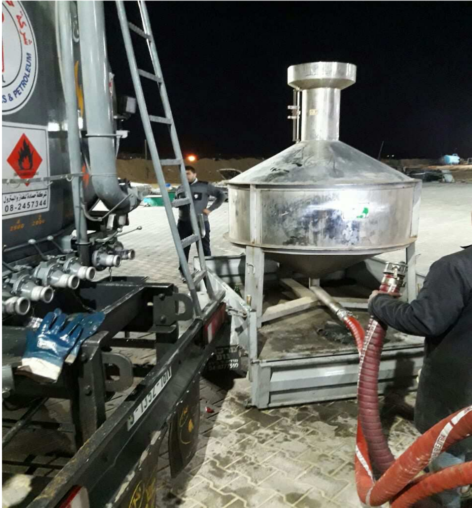
شكل (4.5) حجرة المعايرة وسيارة وقود أثناء المعايرة، المصدر: الباحث.
