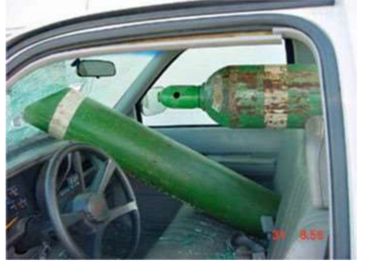
الأضرار الناجمة عن الاسطوانات المخزنة بشكل غير ملائم وغير المقيدة في سيارة، والتي توقفت فجأة. يرجى ملاحظة: الصورة لأغراض توضيحية فقط. ألوان الاسطوانات لا تتوافق مع المعايير الأسترالية.
