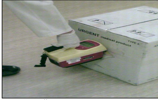
شكل ٤: مثال لأحد أنواع أجهزة المسح الإشعاعي، يتم استخدامه للكشف عن الإشعاع داخل طرد مواد مشعة.
