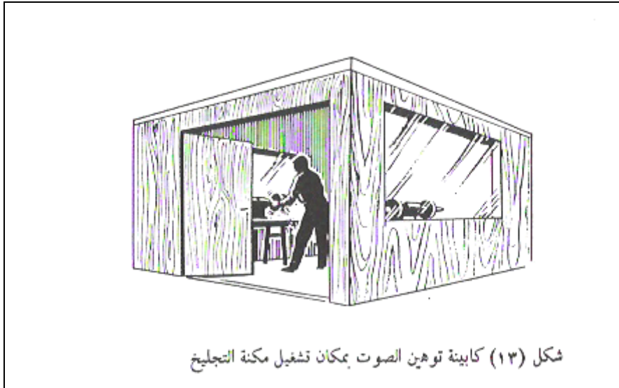
شكل (١٣) يوضح كابينة توهين الصوت بمكان تشغيل ماكنة التجليخ
