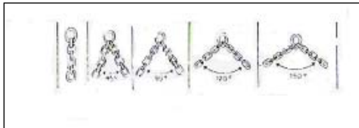
شكل (٤٤) طاقة (قدرة) التحميل الآمن للسلاسل
