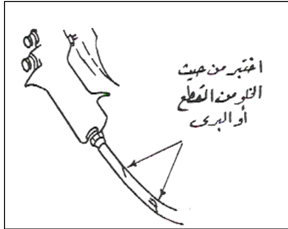
شكل (٨٠) يبين العدة التي تعمل بالهواء المضغوط
