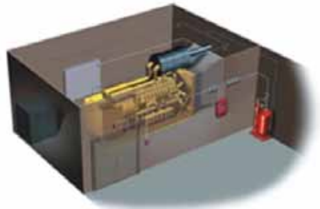
نموذج لحماية غرفة محرك باستخدام نظام رذاذ الماء القائم على وحدة الاسطوانات
