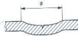
الشكل رقم أ/٢ - انبعاج للداخل يحتوى على قطع أو إزالة معدن
