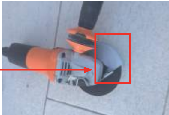
الصورة ٤٩. آلة قطع/جلخ يدوية مزودة بالحماية اللازمة.
