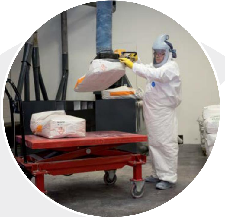
بعد: المنطوق يستخدم رافع فراغ السلطة لنقل حقيبة
