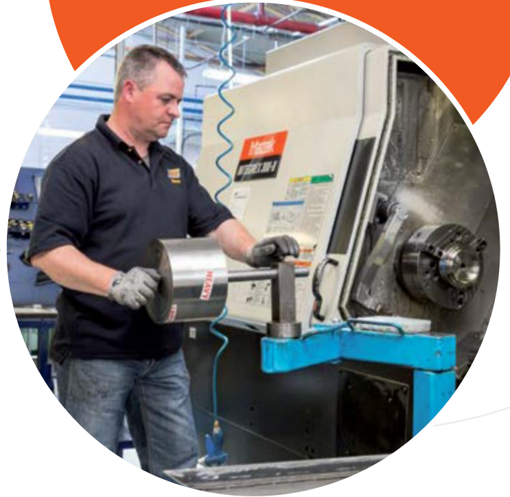
بعد: يستخدم عامل التشغيل محمل البليت المهندس المخصص لنقل البليت إلى جهاز CNC
