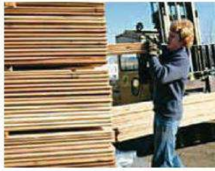
ارتفاع أكوام الخشب يجب ألا يزيد عن (3) م بالتخزين اليدوي ولا يزيد عن (4.5) م بالتخزين الميكانيكي
