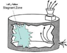
تهوية غير ككافة - حركة الهواء غير ككافة Ineffective ventilation - short circuiting
